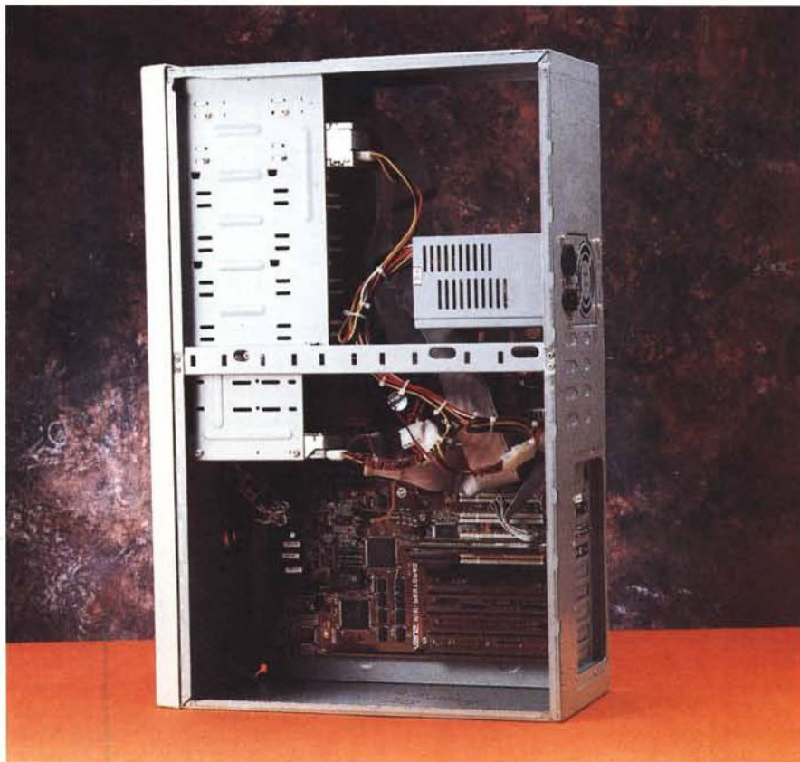
La scheda madre è una Asus P55T2P4D in grado di accogliere due CPU Pentium oppure un solo processore per Socket 7 dei concorrenti di Intel. Questo perché solamente il Pentium è stato pensato e realizzato per l'uso in parallelo con unità dello stesso tipo.
